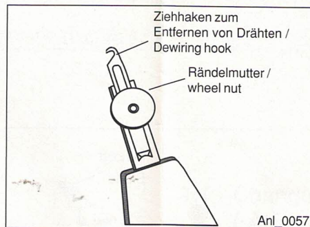
Abb. 8: Ziehhaken zum Entfernen von Drähten Fig. 8: Hook for removing wires
